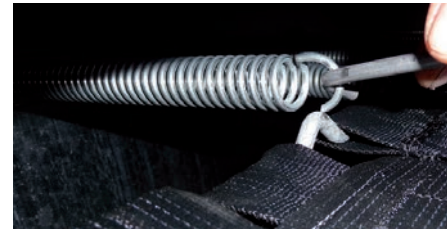
Ein- bzw. Aushängen von Federn mit Einspannhaken
