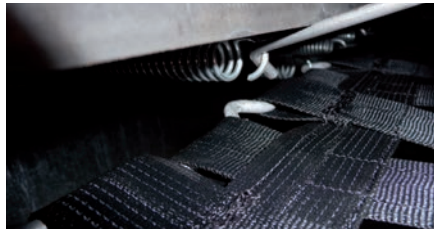
Ein- bzw. Aushängen von Federn mit Einspannhaken
